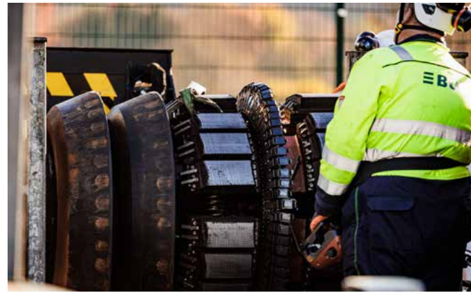
Intelligenter Molch zur Inspektion des TAG Pipelinesystems.
